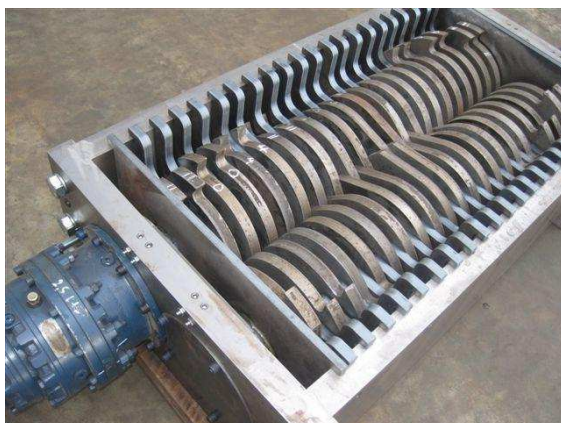
Schneidwerk GRS 60/120 mit Doppelabdichtung
