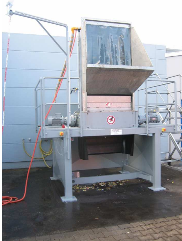
GRS 60/120 mit Edelstahlschacht, Wasserspülung und Beleuchtung
