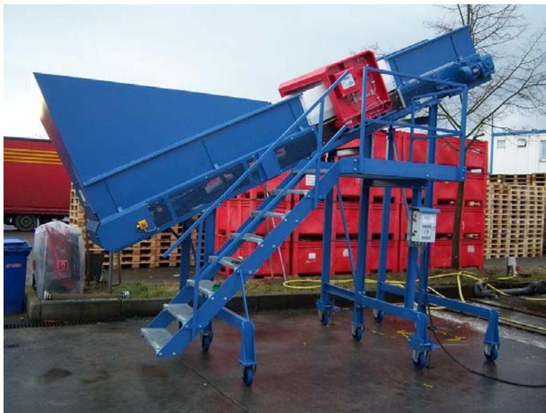
Band mit Allmetallsuchspule zum Maschinenschutz
