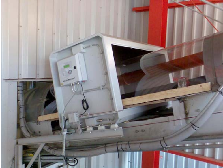
Allmetallsuchspule mit Ausscheideklappe
