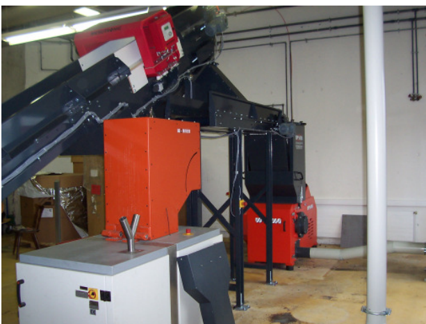
Nachzerkleinerung, wahlweise Beschickung der NZ 310/600 oder der bauseitigen Wannermühle E 30/30
