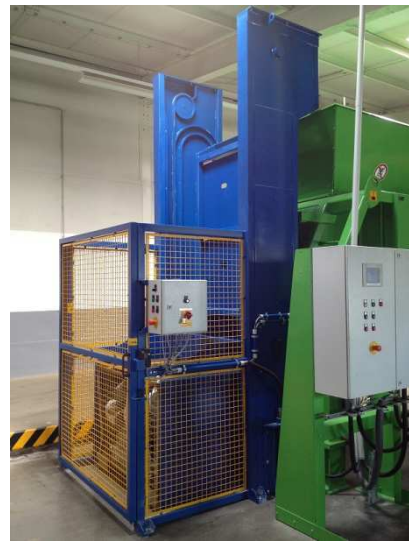
Kippperät für Gitterboxen zur Beschickung des Brechers
